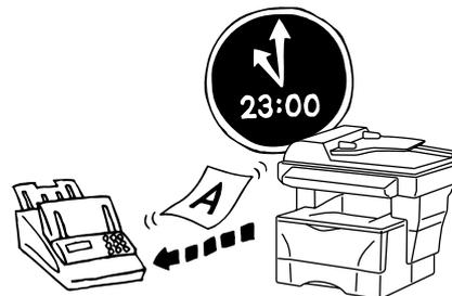
**NOTA:** la trasmissione differita non è disponibile in modalità Trasmissione Diretta. Nella memoria del fax è possibile memorizzare un massimo di 30 lavori per la trasmissione differita. Impostare l'ora corretta sul FAX System prima dell'invio dei documenti mediante questo metodo. Per modificare l'ora, consultare la sezione *Impostazione della data e dell'ora corrente (impostazione Data e ora)* a pagina 2-7.
