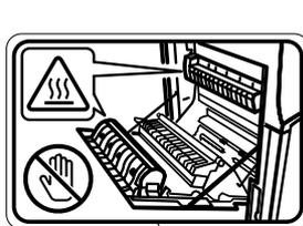
Elevate temperature all'interno. Non toccare i componenti in quest'area: pericolo di ustioni.
