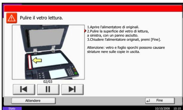
Se, quando si utilizza l'alimentatore di originali, le copie presentano delle strisce nere o delle macchie, pulire il vetro di lettura con il panno di pulizia fornito. Se il vetro di lettura necessita di pulizia, è possibile che venga visualizzato il messaggio *Pulire il vetro lettura*.
