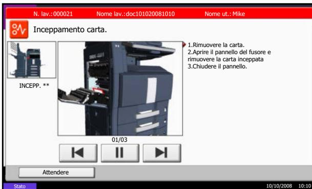
Se si verifica un inceppamento della carta, sul pannello a sfioramento viene visualizzato il messaggio *Inceppamento carta* e il sistema si blocca. Fare riferimento alle seguenti procedure per rimuovere la carta inceppata.
